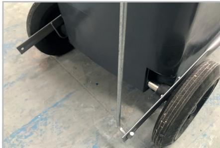
Meter el otro lado de la barra elevadora por el agujero que tiene el pedal en su parte izquierda. La barra del pedal tiene que quedar por dentro del contenedor.
